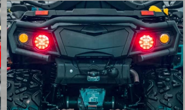
Mini schowek z tyłu pojazdu. Dobre miejsce na narzędzia i linkę. Tylne lampy LED.
