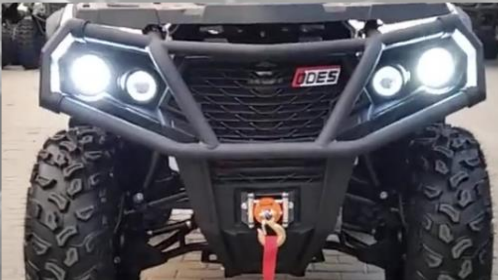
Przód pojazdu z mocnym „kangurem” oraz standardowymi lampami LED. Wyciągarka w komplecie.
